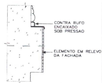
ARREIMATE DE ELEMENTO EM RELEVO DA FACHADA
